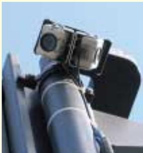
**Lübecker Hafen: Kameras am Hubmast (o.) ermöglichen dem Staplerfahrer über einen Monitor eine gute Sicht nach hinten und vorne.**
